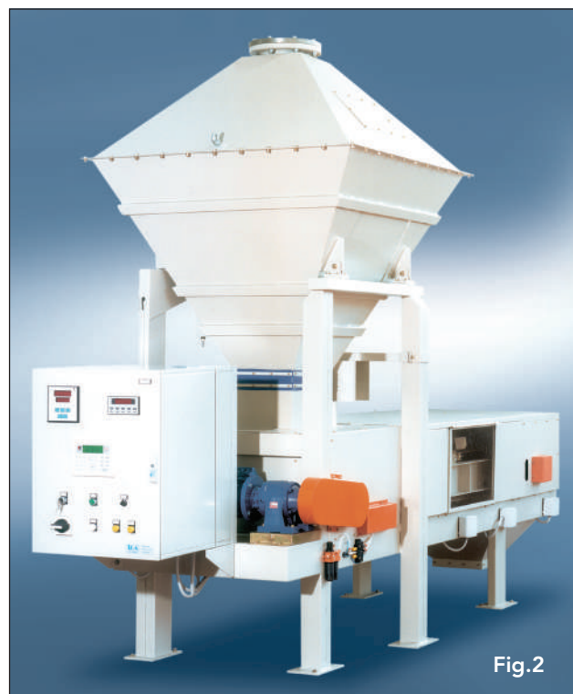
Nastro estrattore-pesatore carenato con tramoggia per controllo di livello e misuratore di U.R. per la determinazione del p.s. apparente di prodotti in polvere.
